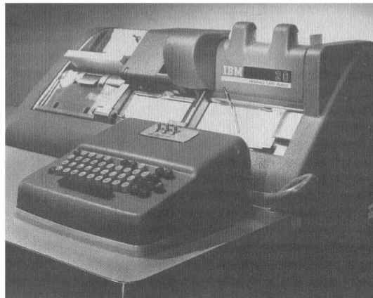
Abbildung 4.7: IBM26 zum Stanzen von Lochkarten (1949)
