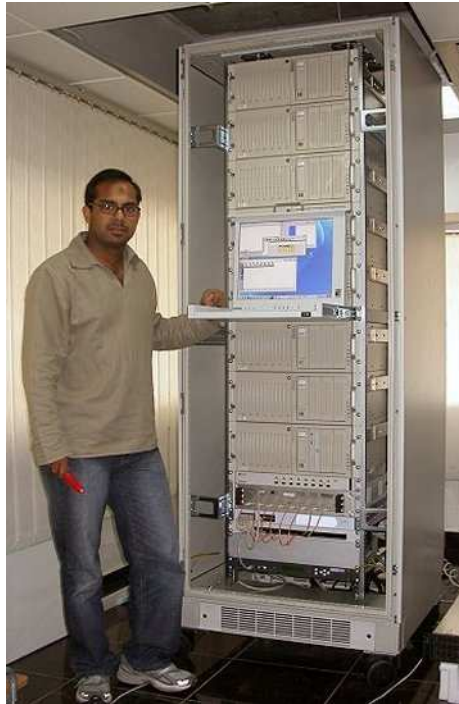
Abbildung 3.15: Hydras Ausbaustufe von 2004: Ein Cluster mit 16 CPUs / FPGA-Karten plus 16 GByte RAM
