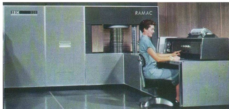
Abbildung 4.12: Das weltweit erste Festplattensystem: IBM's RAMAC (1957)
