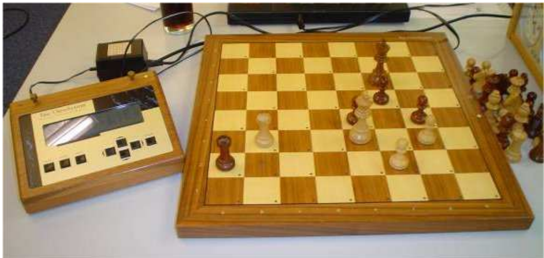
Abbildung 4.39: Tasc R30 trennt Spielbrett und Rechen-/Steuereinheit
