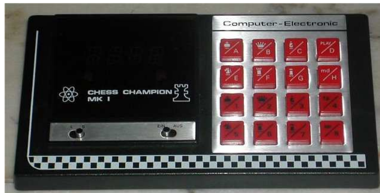
Abbildung 4.30: Bei Schachcomputern wie dem Novag Chess Champion MK I findet der Zugaustausch in Textform statt
