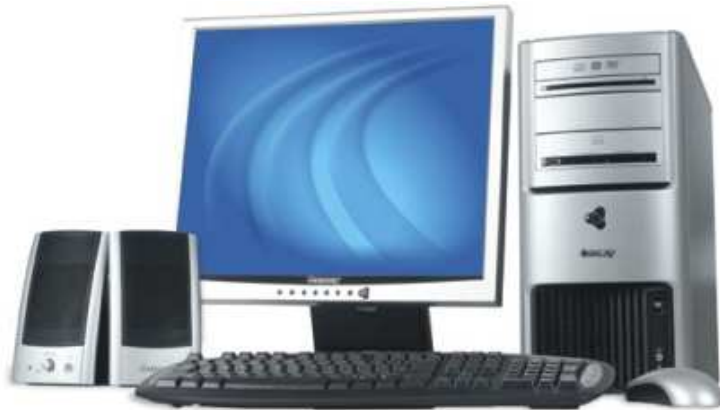
Abbildung 4.29: Ein typischer Desktop-PC von heute mit getrennten Eingabeschnittstellen (Maus, Tastatur), Ausgabeschnittstellen (Monitor, Lautsprecher) und Towergehäuse
