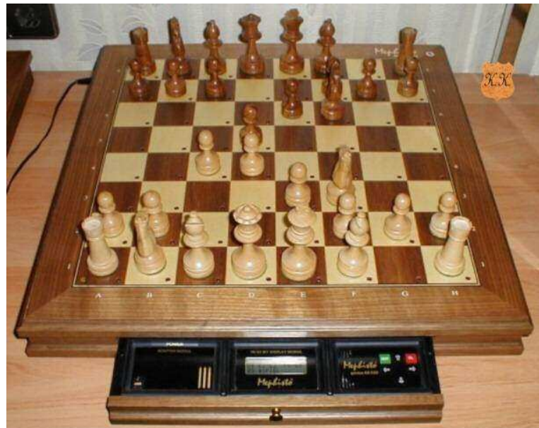
Abbildung 3.18: Der letzte Weltmeister der Brettgeräte: Das Mephisto Genius Modulset (32bit 68030 Prozessor mit 33 MHz) in einem München Magnetsensorbrett
