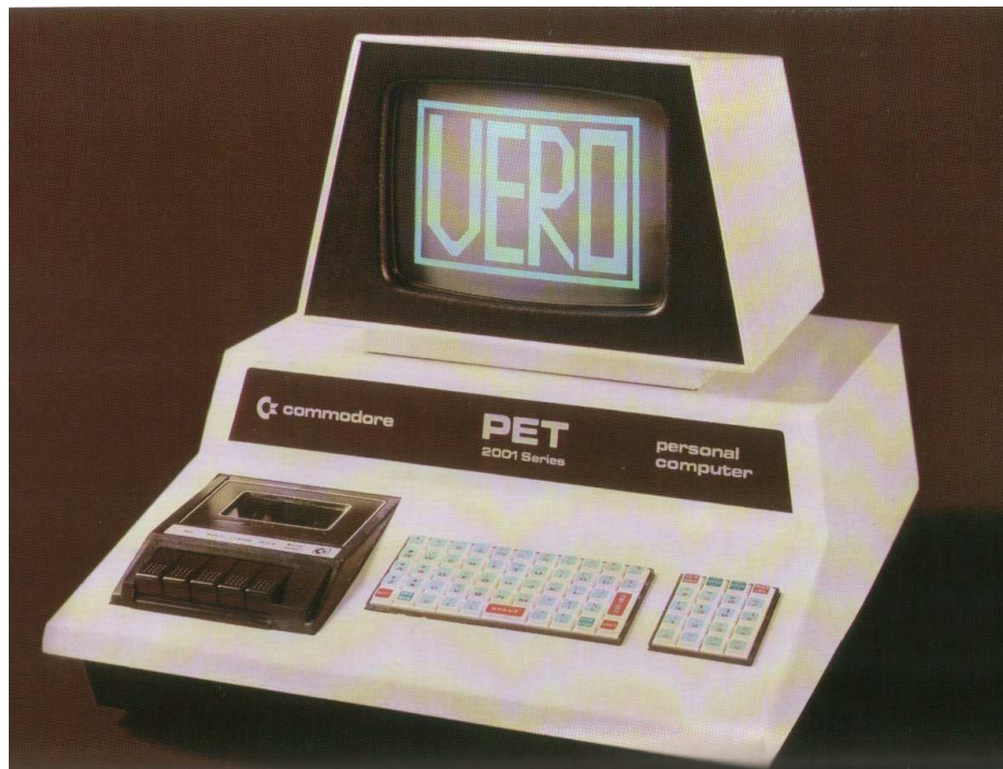
Abbildung 4.22: Der Commodore PET 2001 Heimcomputer mit integriertem Bildschirm, Tastatur und Kassettenlaufwerk
