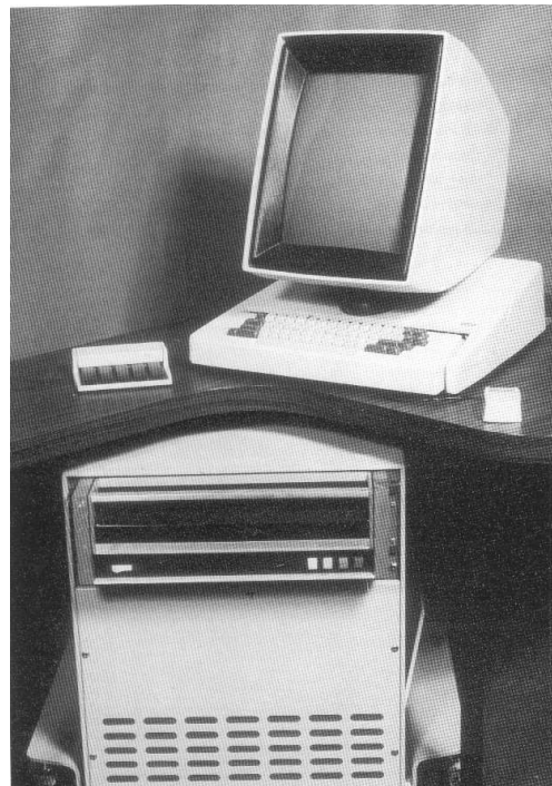
Abbildung 4.27: Der im PARC entwickelte Alto (1974) hat als erster Computer eine grafische Benutzeroberfläche
