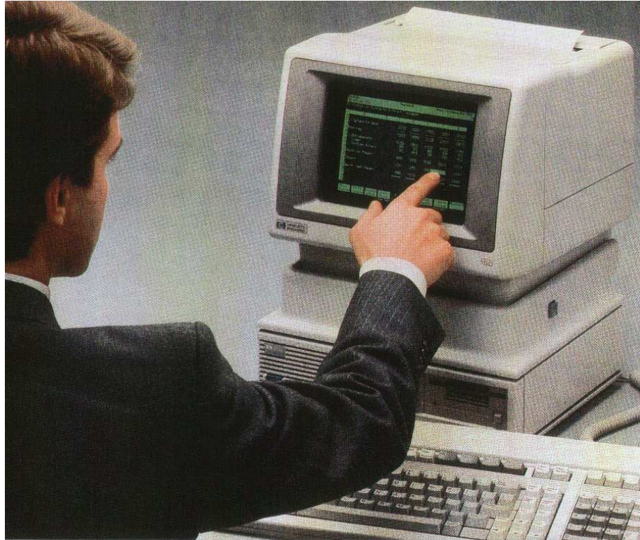
Abbildung 4.25: Durch den Touchscreen lässt sich der HP 150 Computer direkt über seinen Bildschirm bedienen
