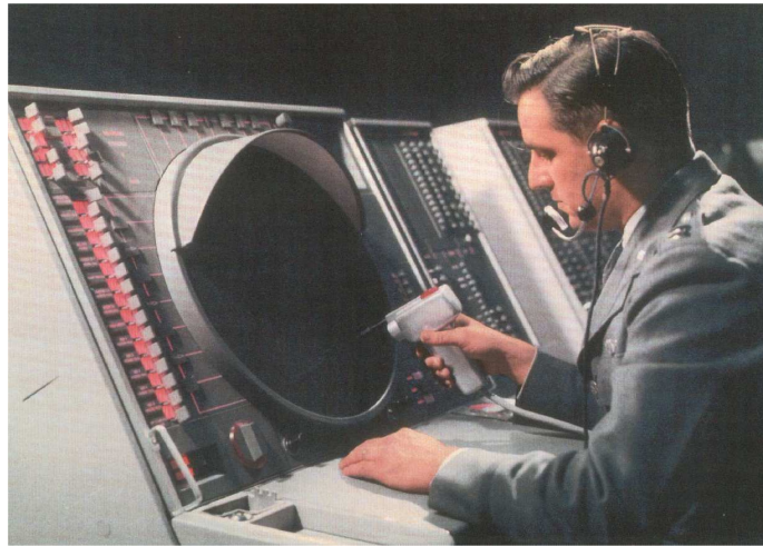
Abbildung 4.9: SAGE Bedienkonsole mit Lightpen (1955)
