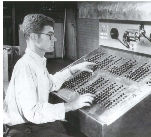
Abbildung 4.6: Schalterkaskade zur Programmierung (1949)
